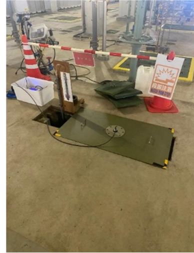
①クランプオン型濃度計（左）②ドップラー式流量計（中央）③ 非接触レベル計流量計（右）
